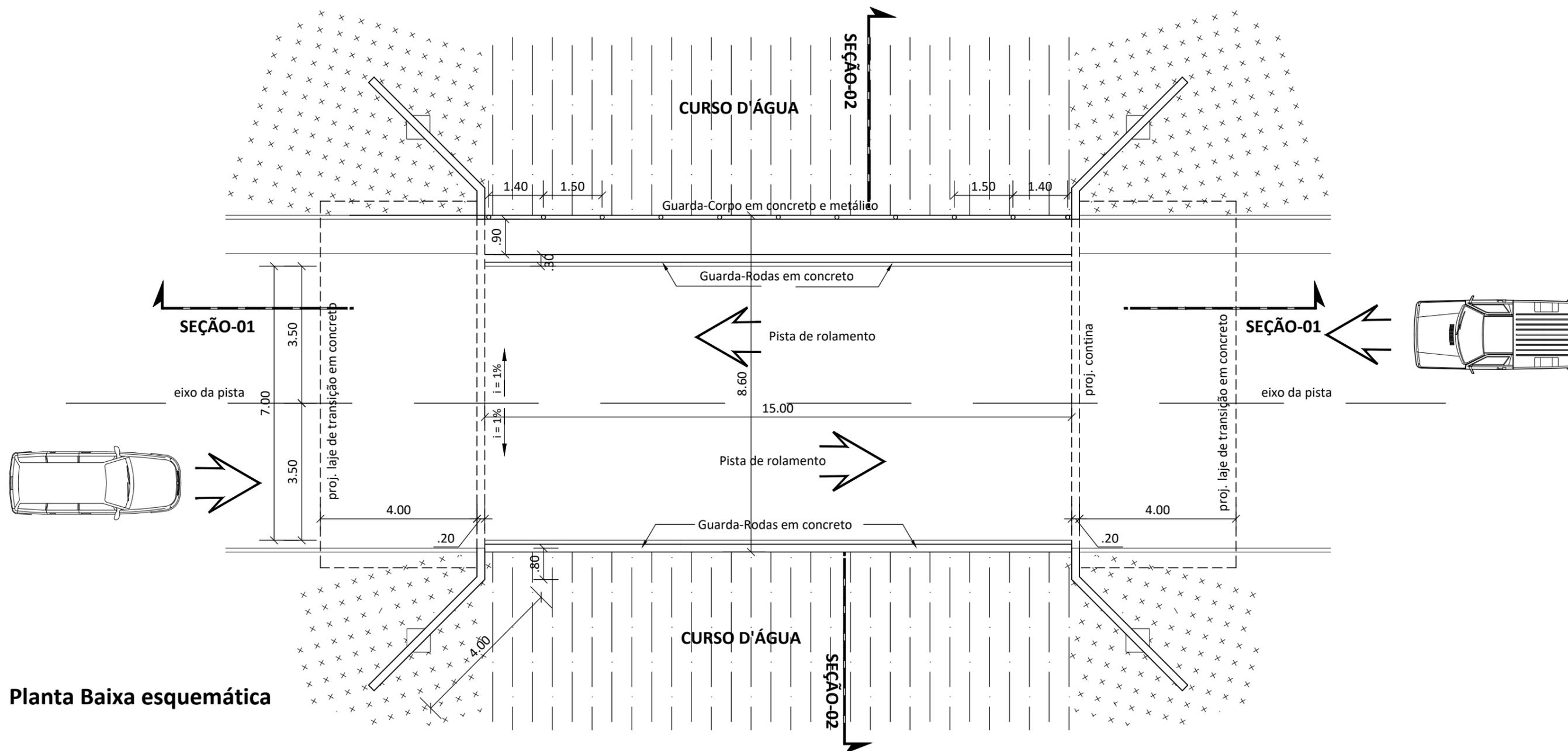
**Planta Baixa esquemática**
